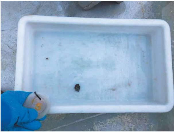
Figur 10: Bilde som viser grabbinhold fra stasjon 5. Det ble ikke registrert sediment ved stasjonen, kun fjellbunn. Foto: Aqua Kompetanse AS.
